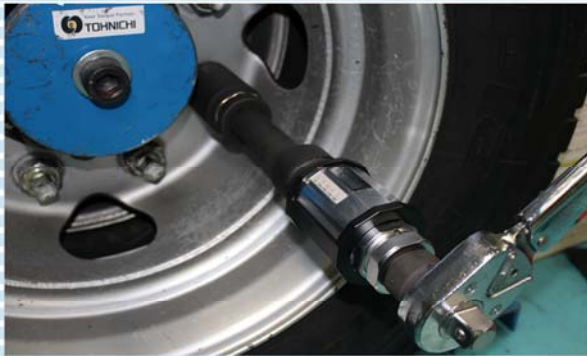
ST1000N3-G mit Drehmomentschlüssel in Klick-Ausführung für das Anziehen von Rädern
