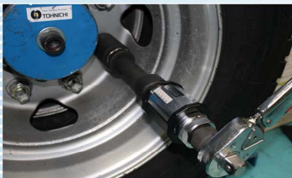
ST1000N3-G 配合脱跳式扭力扳手用于轮毂紧固
