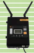
受信機 R-CM に無線モジュール M-FH を搭載した例
